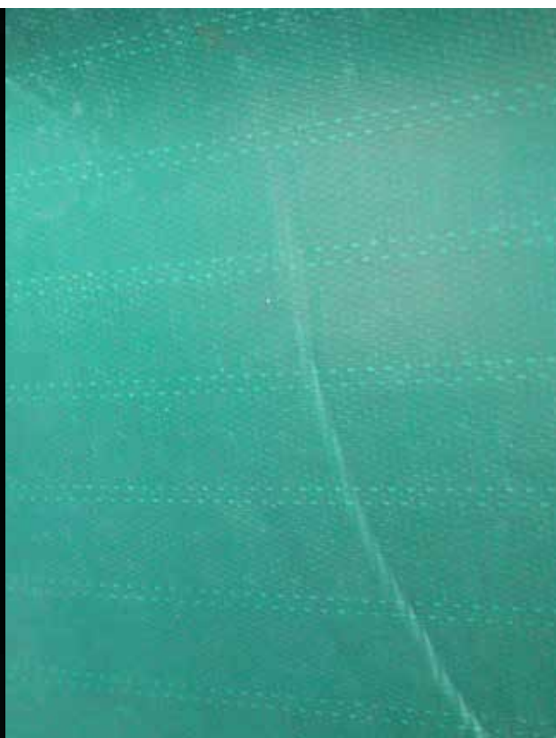
Billede 5. Presenningen er forstærket med ekstra vævninger for at sikre en høj styrke
